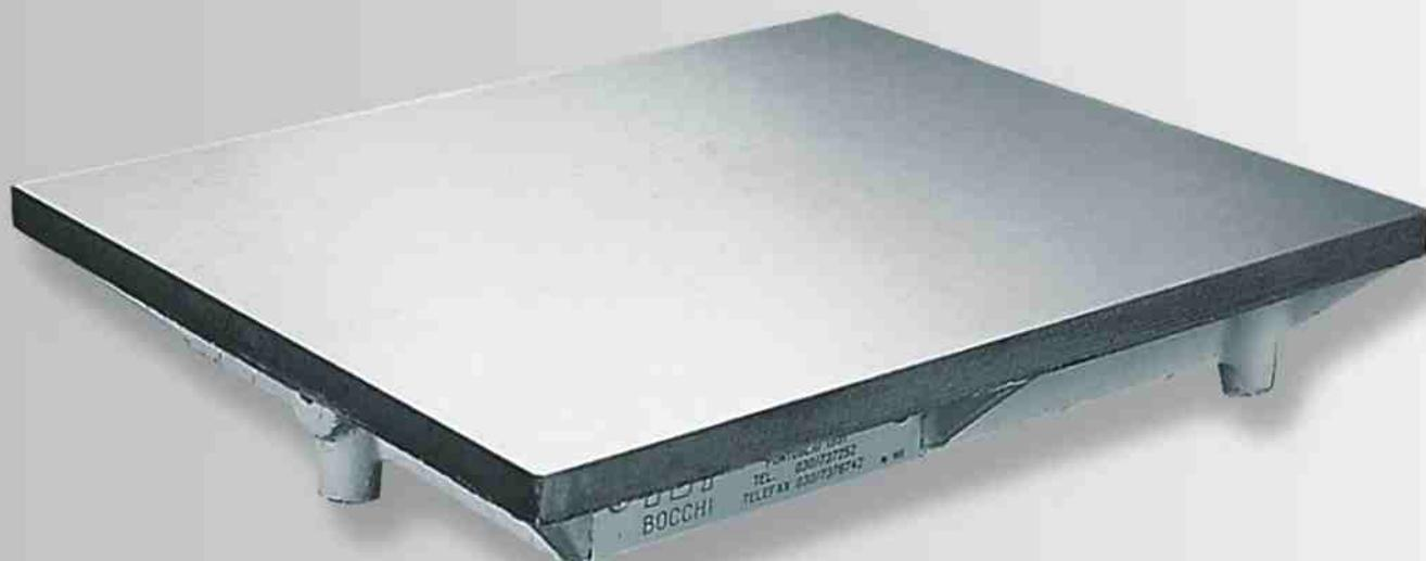
**Piano di riscontro in ghisa G25** esente da soffiature o imperfezioni strutturali. La stagionatura della ghisa viene ottenuta naturalmente. La struttura perlitica con appoggi e nervature disposte in modo da poter opportunamente contrastare le tensioni che si verificano quando il piano viene sottoposto a carichi. I bordi sono finiti a macchina ortogonali tra loro e la superficie di riscontro. La superficie del piano è rettificata secondo norma DIN 876/1.
