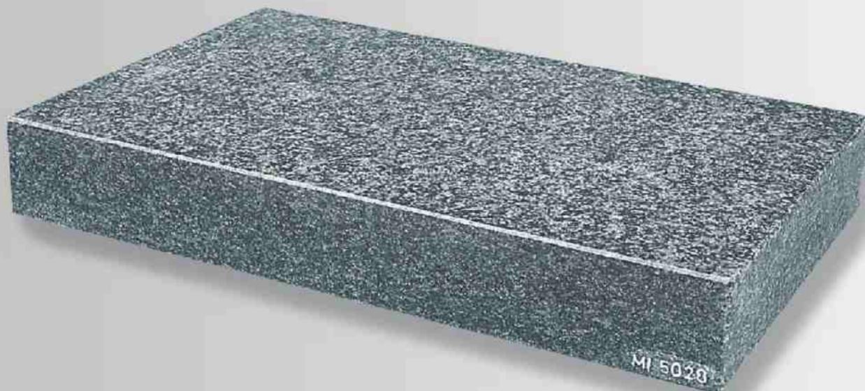
**Piano di riscontro in granito nero.** Costruito in una struttura omogenea e compatta, di altissima precisione per sale metrologiche. Vista la possibilità di poter ottenere tolleranze estremamente precise i piani in granito presentano innumerevoli vantaggi quali: assoluta resistenza alla corrosione, non magnetici e non conduttori e con usura minima nel tempo. La superficie del piano è lappata. Il grado di esecuzione è extra con tolleranza DIN 876/00.
